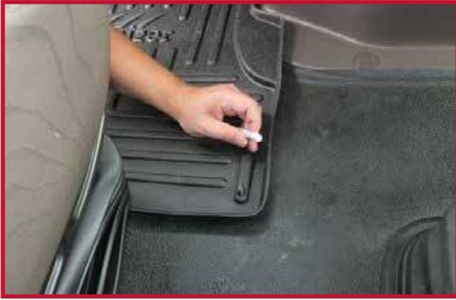
9. Marque con un dedo la posición aproximada en la que deberá fijarse el gancho al piso. Una vez localizada la posición, retire el tapete del conductor del camión.
