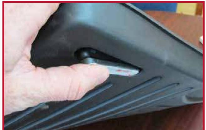
8. Una vez colocado el gancho, deje que el tapete y el gancho se apoyen en el piso como se muestra en la figura 6. A continuación, confirme que el tapete no interfiere con los pedales y verifique que hace un contacto adecuado con las superficies que rodean el piso.
