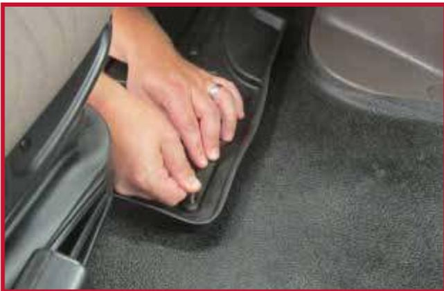
16. Para lograr una adhesión óptima, no mueva al gancho durante un período de 20 minutos después de la instalación
