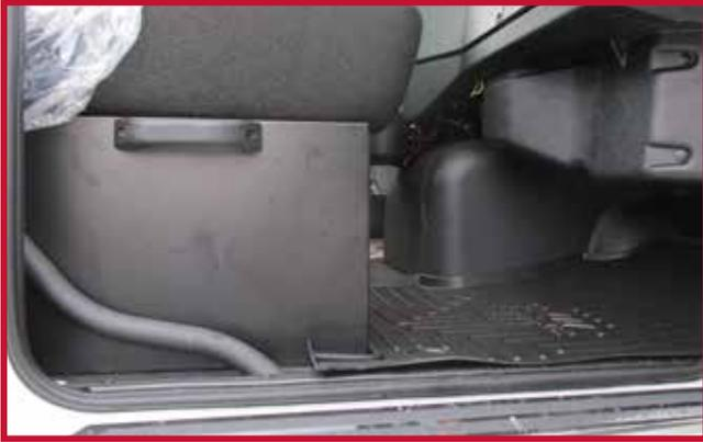
19. Mueva los pedales del acelerador, del freno y del embrague en toda su amplitud de movimiento para confirmar que no hay interferencias con el tapete Minimizer.
