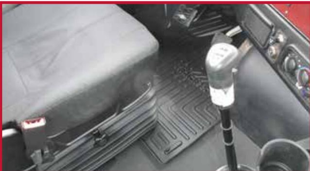
Marque la posición aproximada en la que debe fijarse el gancho al piso. Una vez localizada la posición, retire el tapete del conductor del camión
