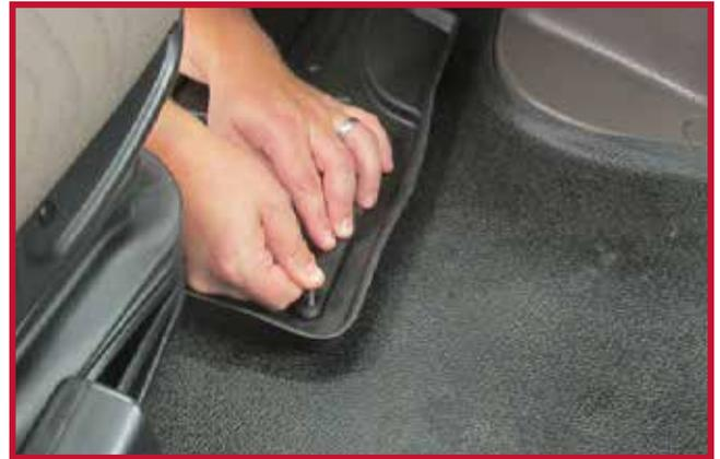
15. Coloque el tapete del pasajero en el camión. Asegúrese de que el tapete del pasajero está empujado completamente hacia delante para que el borde exterior haga pleno contacto con el panel de revestimiento de la cabina y la pared de fuego, como se muestra en la figura 11.
