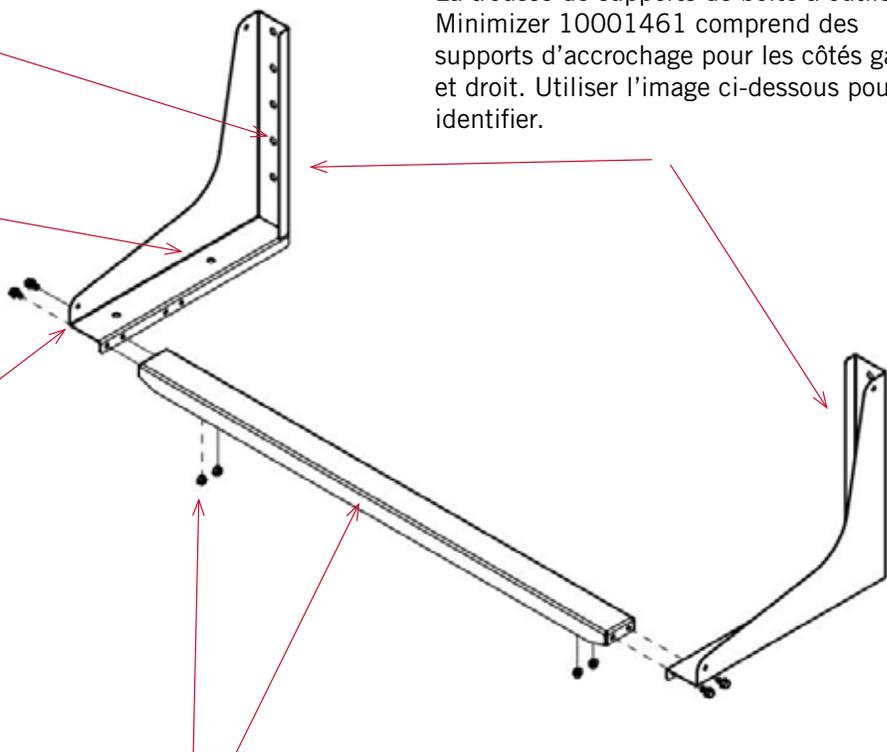
Fixer le support central (10001546) aux supports d'accrochage gauche et droit. Utiliser le jeu de 4 boulons et écrous de la trousse de matériel 10001546 illustré ci-dessus.
