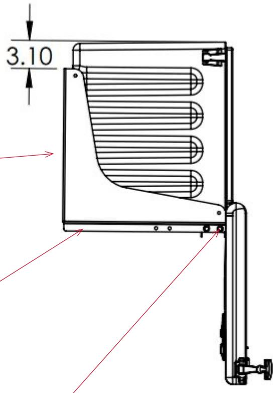
Laisser un espace libre entre l'assemblage de supports et la porte lorsqu'elle est en position ouverte.
